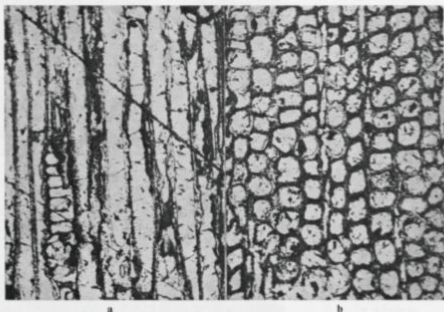
Sl. 34. Sebrrelje. Piritna pseudomorfoza po rastlinskem ostanku. a) Tangencialni presek. b) Prečni presek. Odsevna polarizirana svetloba, 45 \times .
