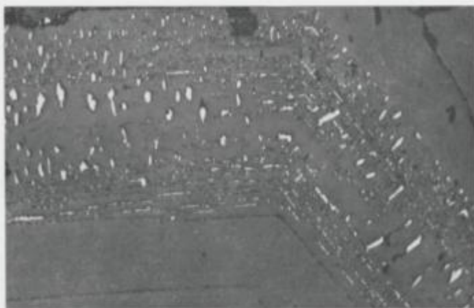
Sl. 26. Zirovski vrh, obzorje 480 m. Detajl slike 25 kaže piritove vključke v kalcitnih zrnih. Odsevna polarizirana svetloba, 125 \times .
