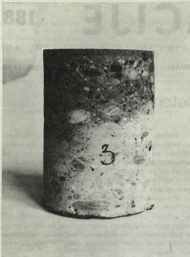
Sl. 3. Porozna epoksidna obloga, kjer se vidi globina penetriranega olja
