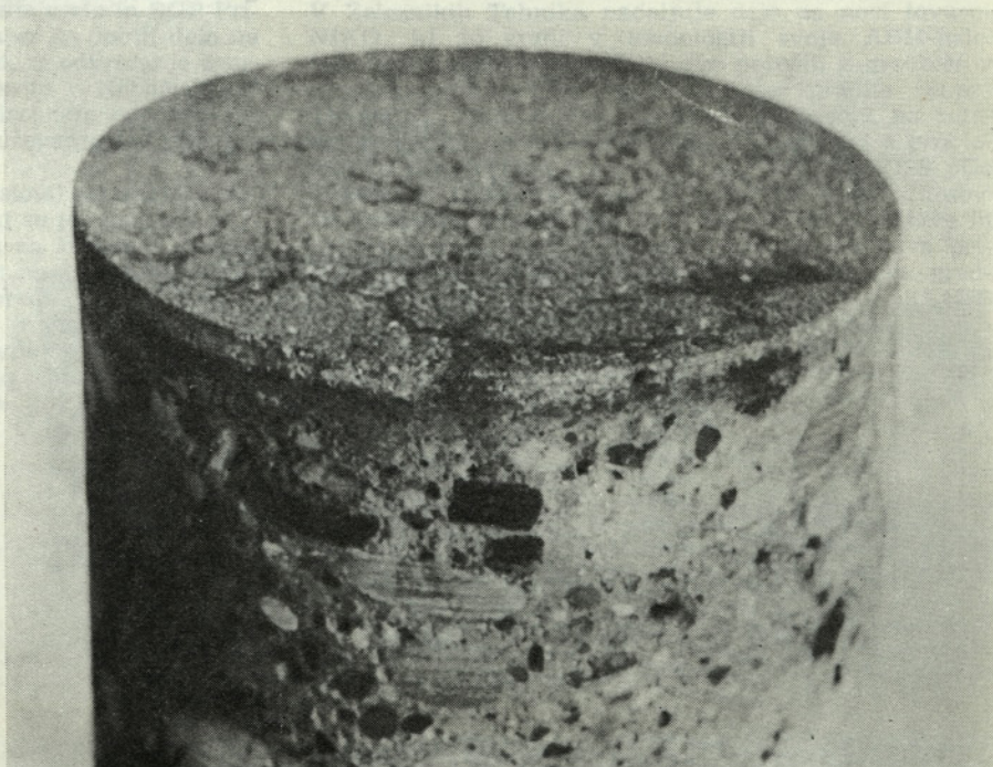
Sl. 4. Razpokana površina epoksidne obloge
