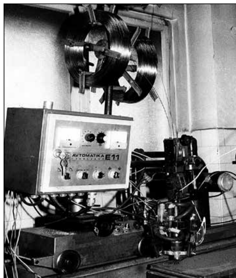
Varilna naprava s trošično elektrodo, ki je bila razvita na Fakulteti za strojništvo in je konec osemdesetih let prejela mednarodno priznanje. Foto: arhiv družine Tušek
