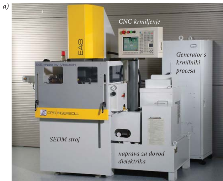
Slika 2: SEDM-naprava (a) in SEDM-naprava z robotom (b)
