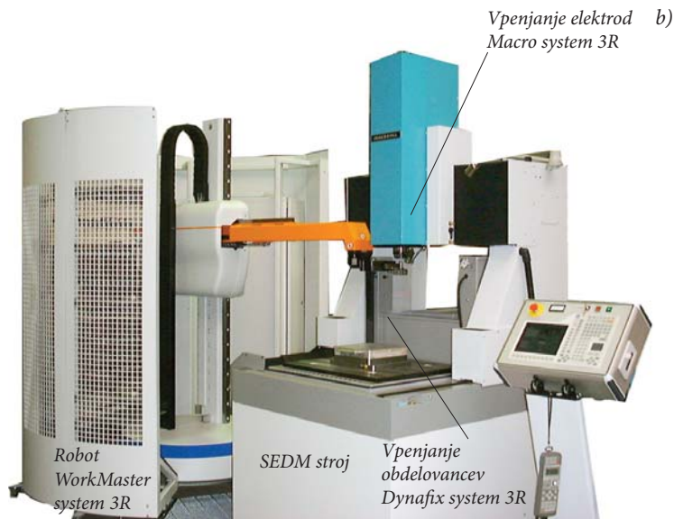
Slika 2: SEDM-naprava (a) in SEDM-naprava z robotom (b)
