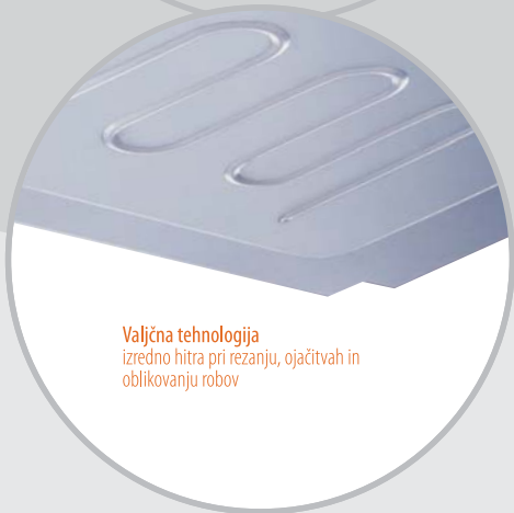
Trumf multibend upogibanje zunanjih in notranjih kontur do višine 25 mm
