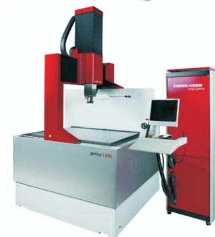
Slika 4: Portalna (Gantry) konstrukcija elektroerozijskega stroja
