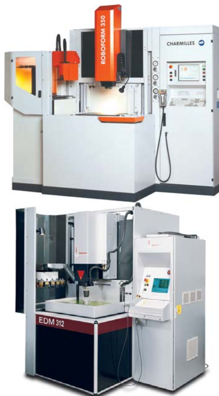
Slika 3: C-konstrukcija elektroerozijskega stroja
