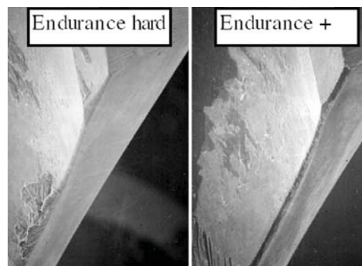
Slika 3: Nastanek sprimkov na rezalnem robu 6-milimetrskega svedra iz karbidne trdine po izvrtanju ene luknje
