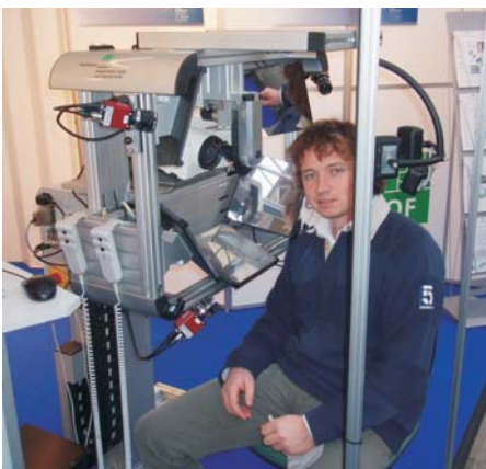
Naprava za skeniranje obraza. Zrcala zagotovi- jo, da ni mrtvih kotov.
