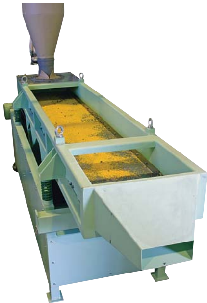
Slika 3: Vibracijsko sito s sušilniki
