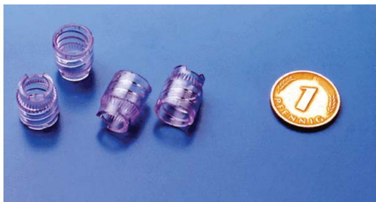
Slika1: Izdelek iz polikarbonata z navojem
