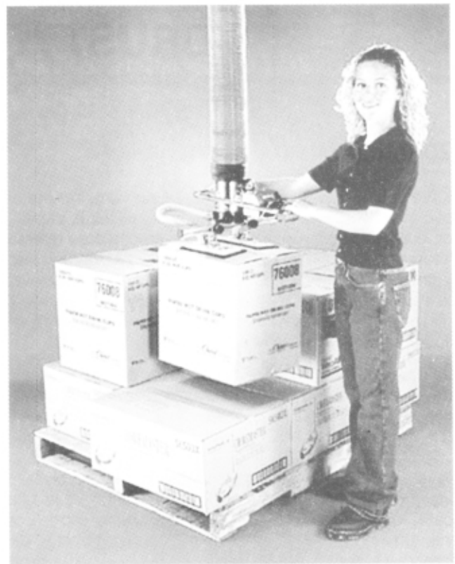
Slika 6: Vakuumsko prijemanje kartonskih škatel
