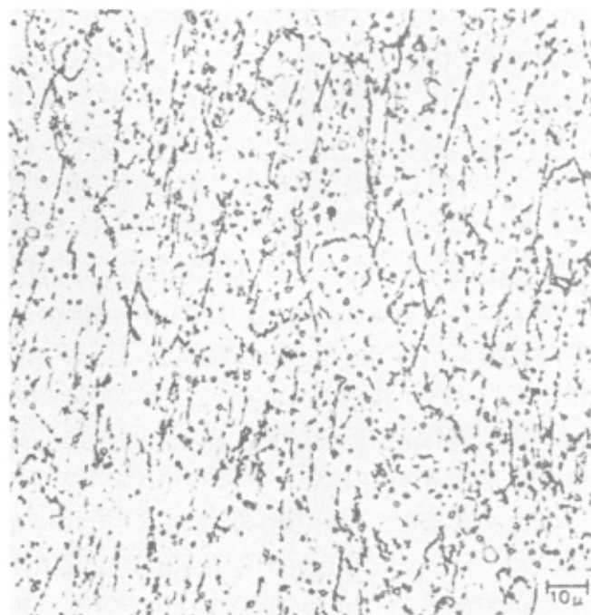
Slika 2: Mikrostruktura (a) lite zlitine Co-Cr-Mo, ki kaže interdendritne karbide, (b) kovane zlitine Co-Cr-W-Ni, ki kaže drobno zrnato avstenitno mikrostrukturo [1].
