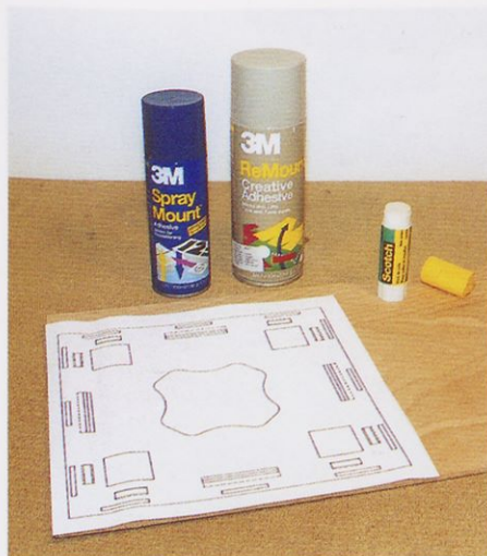
Slika 9. Odstranljivo lepilo v pršilki in stiku; med njima ni nobene razlike, vendar je nanašanje lepila iz pršilke na večje površine hitrejše in enakomernejše. Ko se lepilo v 15–30 sekundah osuši, papir s prefotokopiranim načrtom lahko pritisnete na vezano ploščo.
