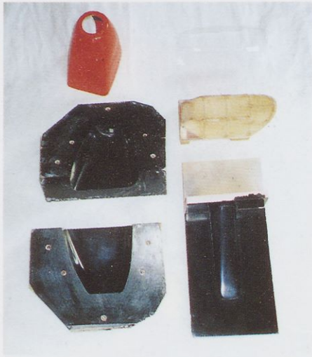
Slika 2. Na sliki sta polovici kalupa za pokrov motorja, kalup za del okrog izpušne cevi in pozitiv za kabino. Zraven so še izgotovljeni izdelki.
