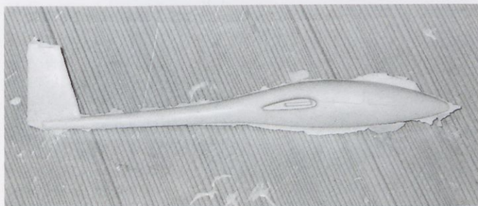
Slika 6. Ko je ulitek dokončno strjen, odstranimo film, ki je nastal na meji med obema polovicama kalupa.
