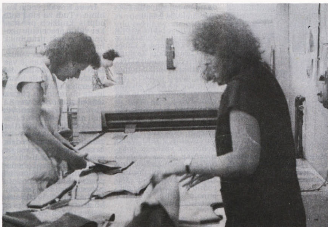
V Zali so veseli nove pridobitve — fiksirne preše. Skrajšala jim je čas na tej operaciji, porabi pa tudi manj energije, kot je prejšnja preša.
