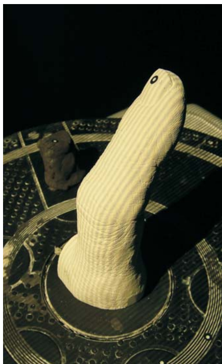
Slika 8: Digitaliziranje mavčnega modela prsta
