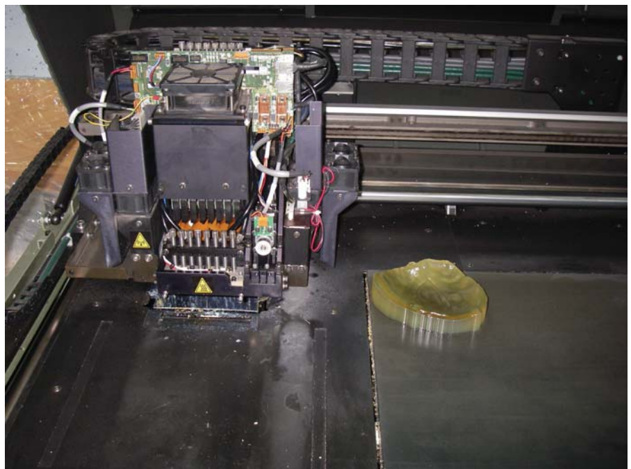
Slika 6: Tiskalnik OBJET EDEN 330, s katerim je bil izdelan pramodel lobanjskega vsadka
