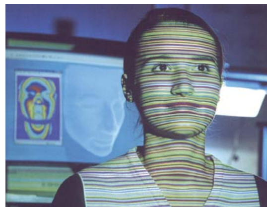
Tridimenzionalno skeniranje obraza: nov postopek določanja obrisov s projiciranjem barvnih linij
