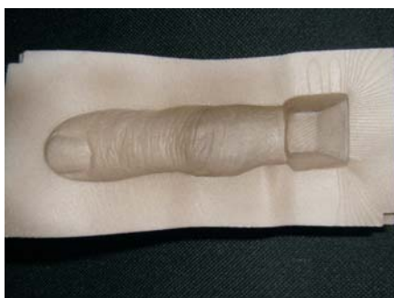
Slika 19: Del orodja, izdelan s tehnologijo SLS
