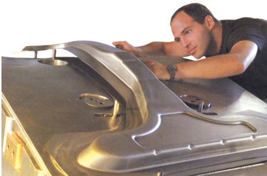
Tesnost orodja je ključnega pomena za kakovost preoblikovanja pri postopku hydroforminga, ki omogoča izdelavo kompleksnih geometrij. Slika prikazuje preoblikovanje B-nosilca.
