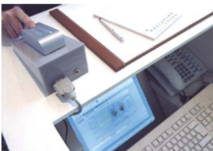
Rutinski postopek: skeniranje odtisa dveh prstov (za primer poškodbe enega) z opremo FinerTip Reader
