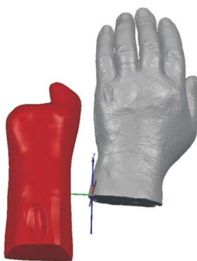
Slika 11: Digitaliziran model krna in zrcaljen model zdrave roke
