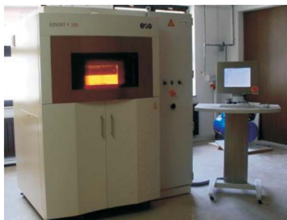
Slika 3: Model ohišja in slika stroja za lasersko sintranje
