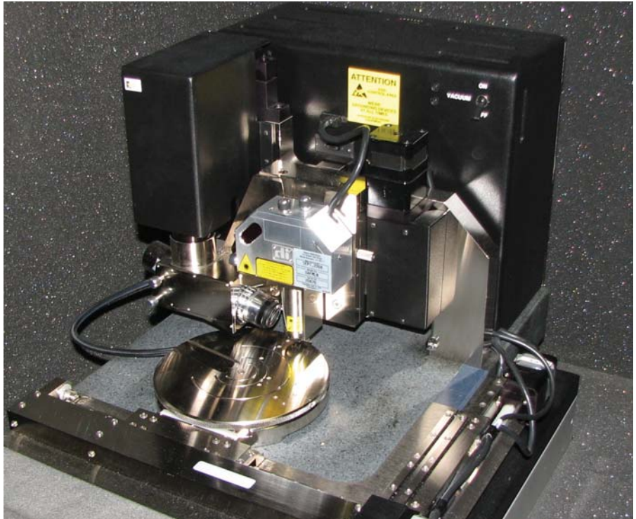
Mikroskop na atomsko silo je nepogrešljiva naprava nanoznanosti in nanotehnologij. (Foto: arhiv IJS)
