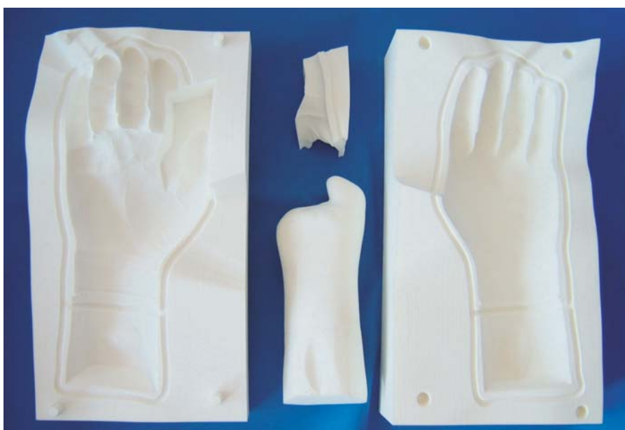
Slika 20: Orodje za protezo po delni amputaciji dlani, izdelano s tehnologijo SLS
