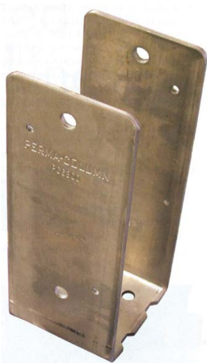
Ta 6,2 mm debel spojni U-člen izdelujejo na novi hidravlični stiskalnici v podjetju Perma-Column. Stiskalnica s podajalnim sistemom proizvaja končno rezano geometrijo v eni operaciji, ki je nadomestila zaporedje več časovno intenzivnih operacij, izvedenih na več strojih.
