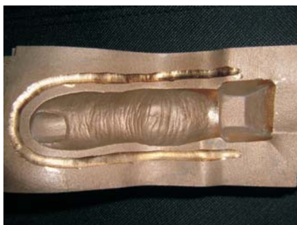
Slika 18: Del orodja za protezo prsta, izdelan s tehnologijo DMLS
