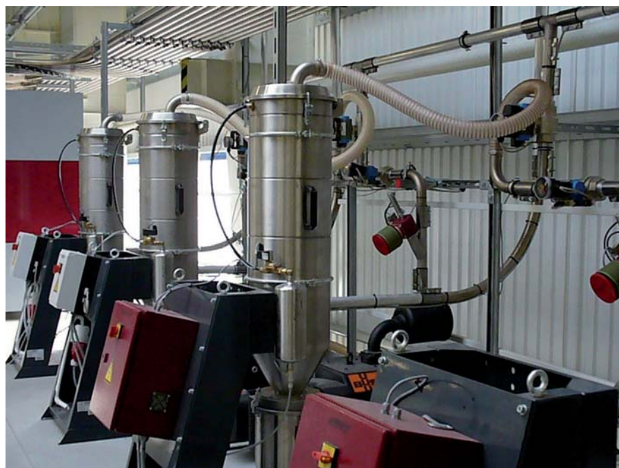
Slika 4: Črpalke, ki zahtevajo malo vzdrževanja, za transport materiala pri visokih pretokih
