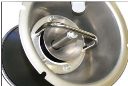
Slika 3: Pnevmatični zvonec izboljša podajanje materiala
