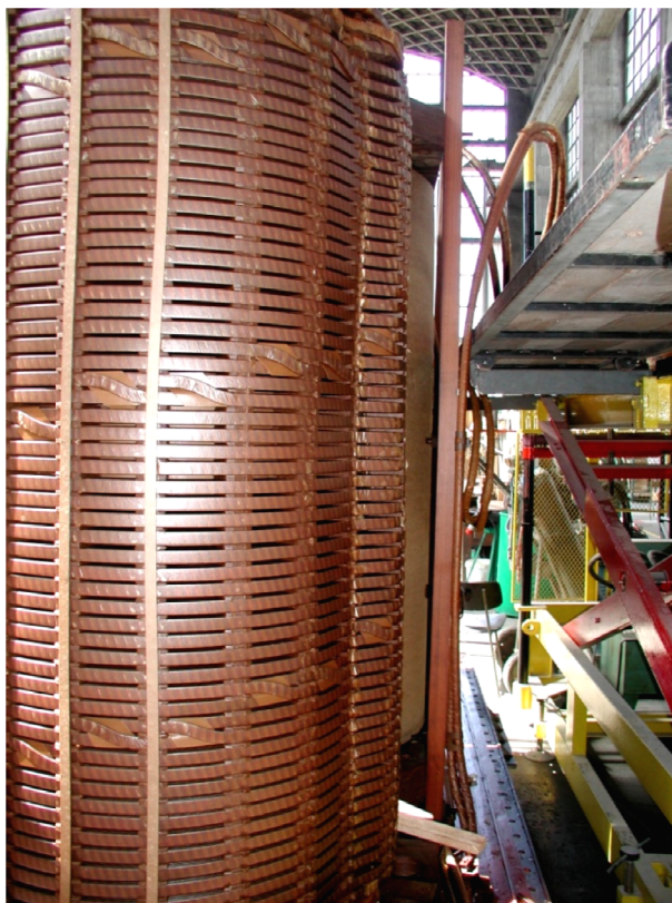
Slika 25: Primer vbočitve notranjega navitja zaradi prevelikih radialnih obremenitev.
