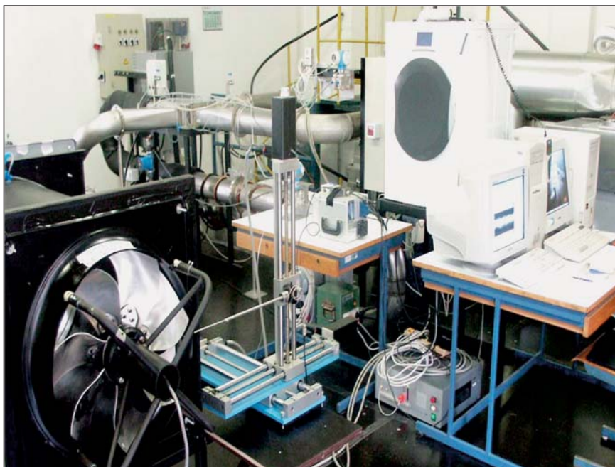
Slika 2. Laboratorij s preizkuševališčema za kondenzatorje in aksialne ventilatorje
