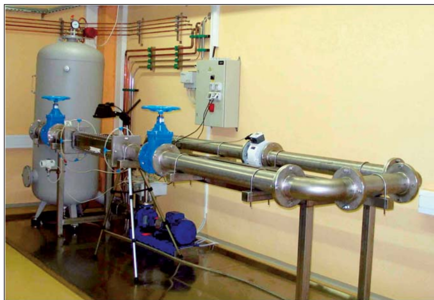
Slika 7. Merilna postaja za raziskovanje hidrodinamične kavitacije
