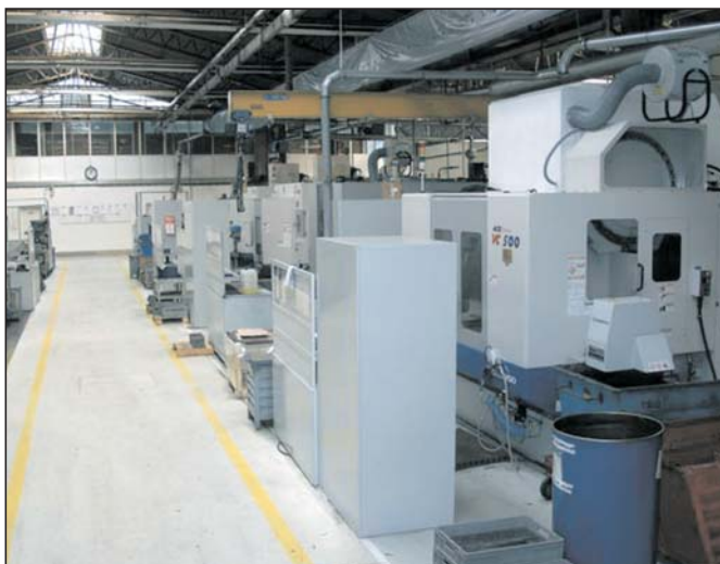
Kladivar: CNC stroji za obdelavo ohišij ventilov
