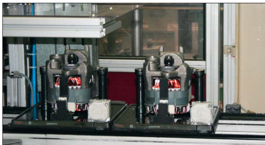
Slika 5. Kompresorska enota na paleti
