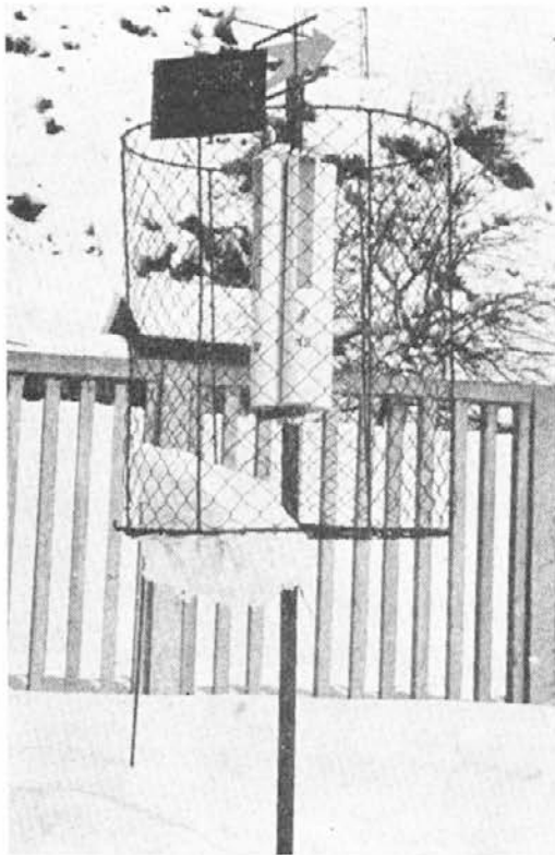
Kontrolna postaja prašnih odsedalnikov v železarni Ravne
