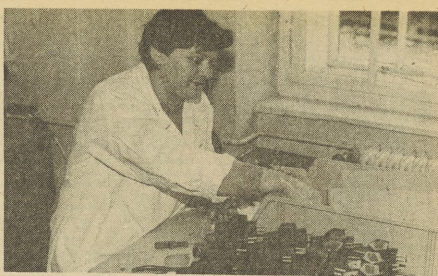
Montaža filtra zoper radijske motnje.
