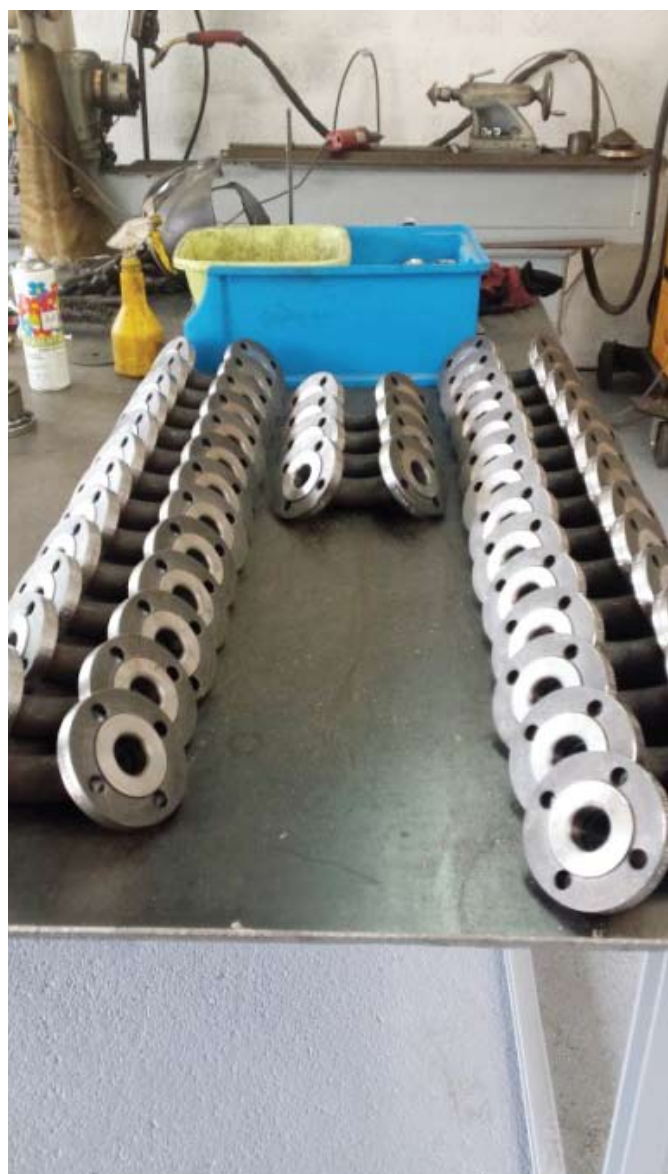
Izgled elementov po zaključeni operaciji varjenja
