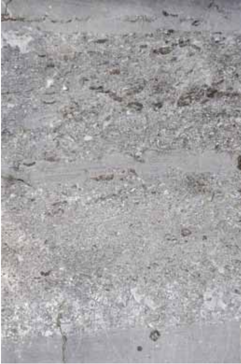
Slika 4: Postopna zrnavost v podpeškem apnencu podstavka Marijinega stebra na Levstikovem trgu. Drobnozrnati spodnji del označuje zgornji del najstarejšega dogodka, ki mu sledita dve popolno razviti postopno zrnati plasti, odloženi v dveh dogodkih. Foto: Matevž Novak.
