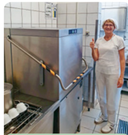
Z novim pomivalnim strojem Hobart AMXXL so zaposleni zelo zadovoljni. Zaradi avtomatskega dviga in spusta pokrova je delo lažje, veliko bolj ekonomična je tudi poraba vode, elektrike in pomivalnih sredstev.
