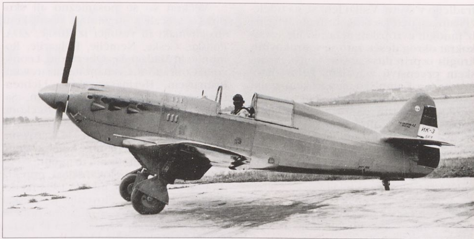
Prototip IK-3 na letališču v Zemunu po opravljenih spremembah hladilnih rež in podvozja (Arhiv avtorja)
