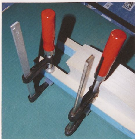
Slika 8. Pritrditev krova iz vezane plošče na stirodurni trup s pomočjo primežev
