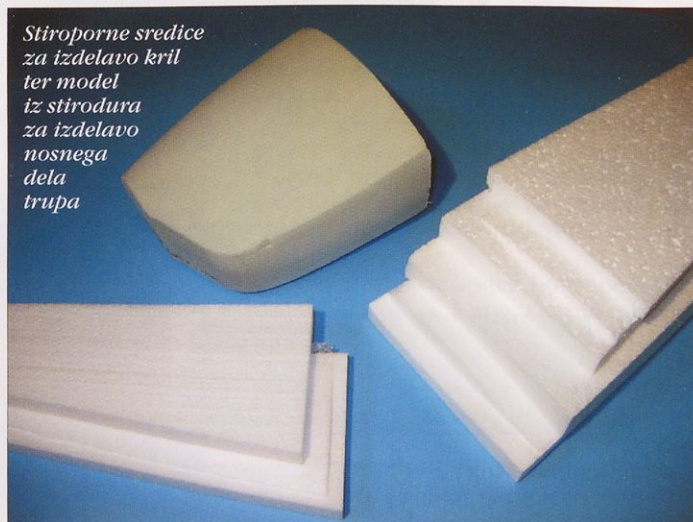
Penasta gradiva: depron, stiropor in stirodur
