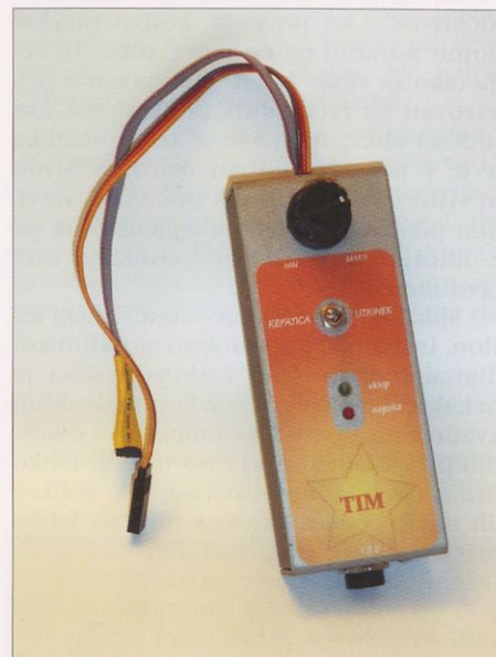
Končni videz naprave za popestritev jaslic. S stikalom izberemo eno izmed svetlobnih predstavitev, s potenciometrom pa pogostost dogajanj na nočnem nebu. Zvezda repatica naj se prikaže le enkrat v minuti.
