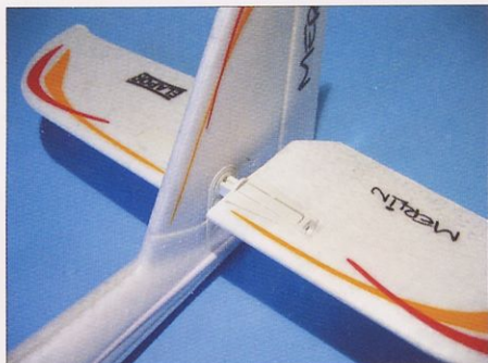
Zelo vsečna in dobrodošla rešitev je popolnoma snemljiv dvodelni višinski stabilizator.
