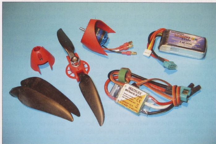
Priporočen pogonski komplet modelu zagotavlja več kot dovolj moči za živahno letenje. Nosilec elektromotorja, nosilec krakov, krake in kapo propelerja dobimo v kompletu z modelom.
