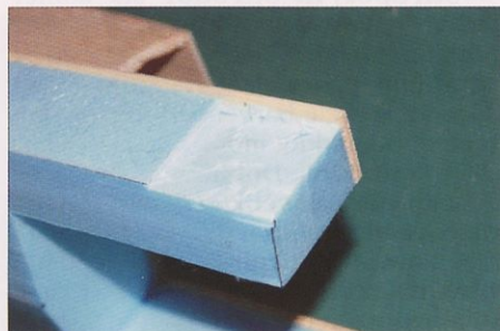
Slika 9. Na obeh bokih trupa na krmi naredimo ojačitev iz vezane plošče 3 mm, kjer bo napeta elastika.
