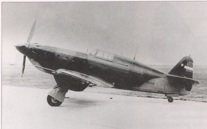
Tretji IK-3 v kamuflirnih barvah. Od prototipa so se serijski IK-3 najbolj razlikovali po enostavnejši kabini in nekoliko predelanemu nosu zaradi vgradnje drugega motorja. (Arhiv Srečka Bradiča)
