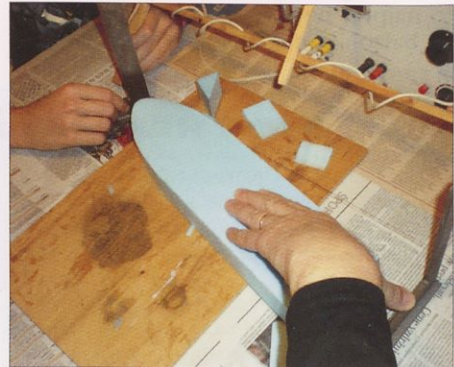
Slika 6. Izrezovanje trupa iz bloka stirodura s pomočjo uporovne žice
