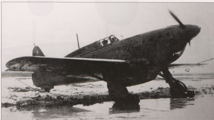
Operativni IK-3. Pred kabino je lepo viden vizir za top in strojnici. (Arhiv avtorja)
