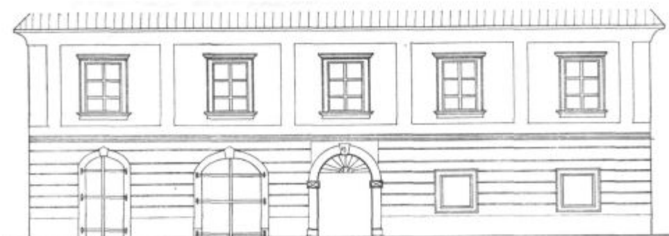
Savinova hiša. Zgoraj: Rekonstrukcija prvotne podobe južne fasade. Na sredi: fasada pred zadnjo restavracijo leta 1972. Spodaj: južna fasada po obnovi. Risal B. Ceh.
