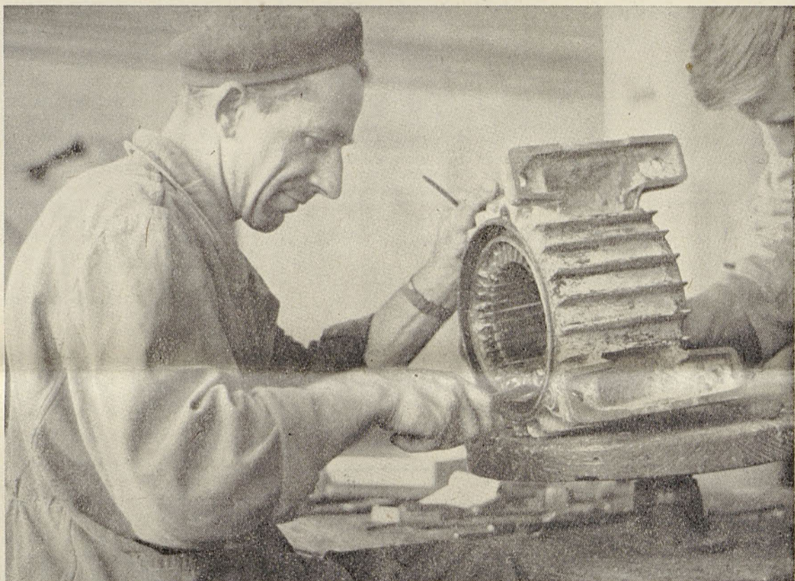
Slavko Mesarič pri čiščenju utorov statorja elektromotorja
