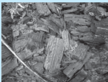
□ Slika 5. Z glivami rjave trohnobe razkrojen les Figure 5: Brown rotted wood
