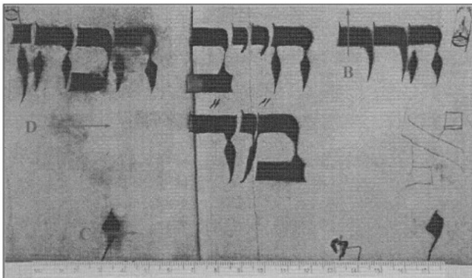
Slika 4: Detajl analiziranega območja na židovskem dokumentu (AS 1080 zbirka Muzejskega društva za Kranjsko, Muzejskega društva za Slovenijo in Historičnega društva za Kranjsko (Collectanea), fas. 2, židovski dokumenti). Črke A, B, C in D označujejo dele, ki so jih prešli s protonskim žarkom.
