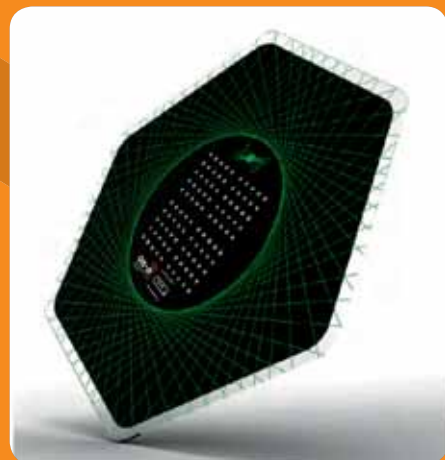
Slika 4: Organski fotodetektor, ki omogoča interaktivno površino (vir: ISORG).
