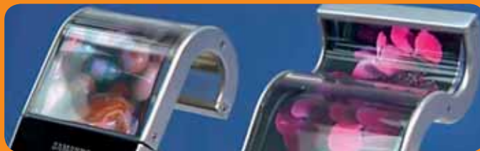
Slika 6: Fleksibilni zasloni na foliji, ki sledijo obliki, v katero so integrirani.
