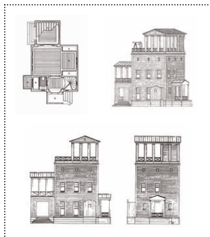
Slika 22. Tipologija hiš Balloon frame sistema na podlagi pregleda področja Upper Midwest. 1850-1920
