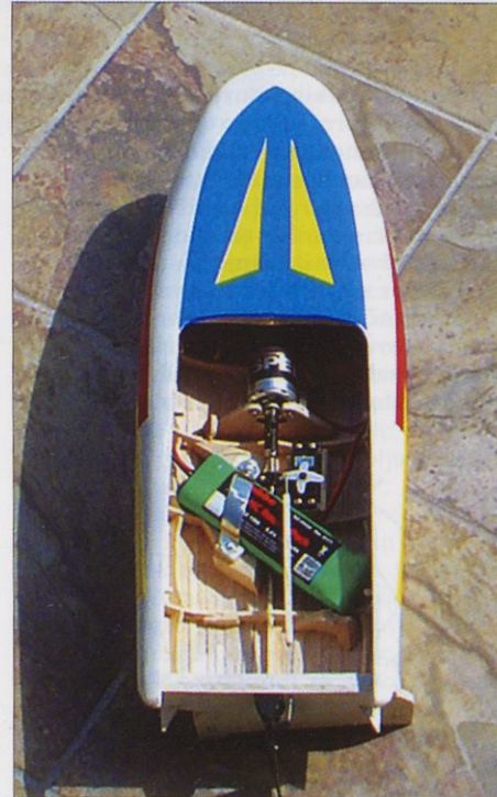
Slika 5. Vgrajeni pogonski sklop z akumulatorsko baterijo
