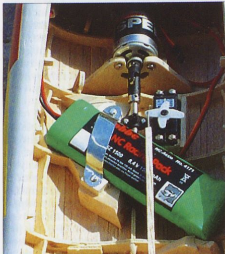
Slika 6. V model je vgrajen Graupnerjev pogonski sklop.
