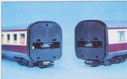
Na vsakem spoju dva petpolna priključka vzpostavita električno povezavo za sprejem toka skozi celotni model vlaka.
