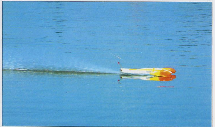
Mibov model fusion kategorije O hydro se pri 110 km/h dotika vodne površine le z ladijskim vijakom in krmilom.
