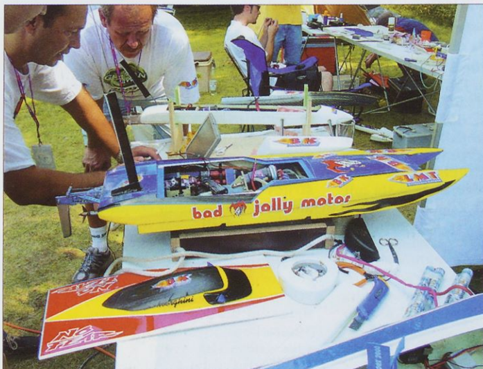
Alex Söll, vodja razvoja pri firmi BK Electronics, s pomočjo prenosnega računalnika optimira parametre brezkrtačnega krmilnika hitrosti pri tekmovalčevem modelu kategorije powerboat 30.
