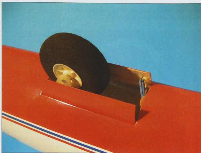
Po Timovem načrtu izdelano uvlačljivo podvozje da še poseben čar in novo dimenzijo uporabnosti manjšim maketam jadralnih letal, kot npr. malemu Mibovemu pilatusu B-4.
