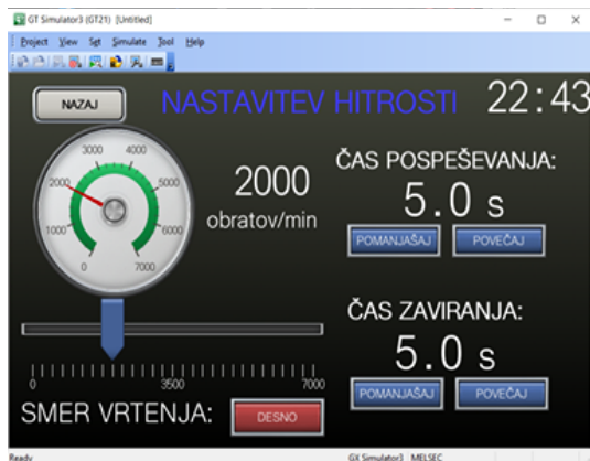
Slika 3: Nastavitev hitrosti motorja (vir: avtorji)
