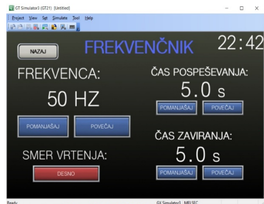
Slika 4: Nastavitve frekvenčnika (vir: avtorji)
