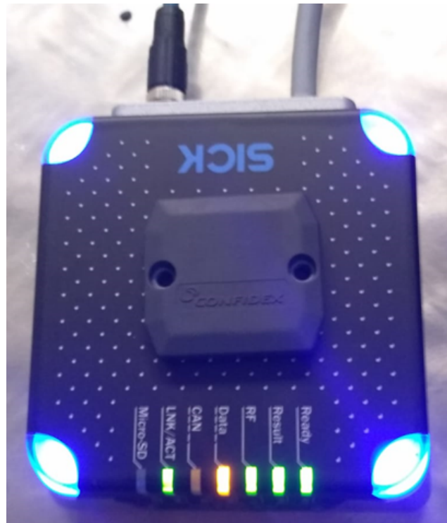
Slika 1: SICK bralnik in značka uporabljeni za testiranje (foto: avtorja)
