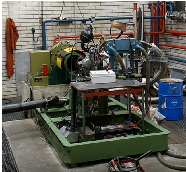
Slika 1: Testni sistem na motorni zavori
