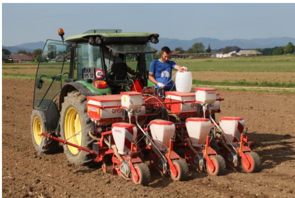
Slika 3. Prilagoditev sejalnice za dodajanje suspenza entomopatogenih ogorčic pri izvedbi poskusov
