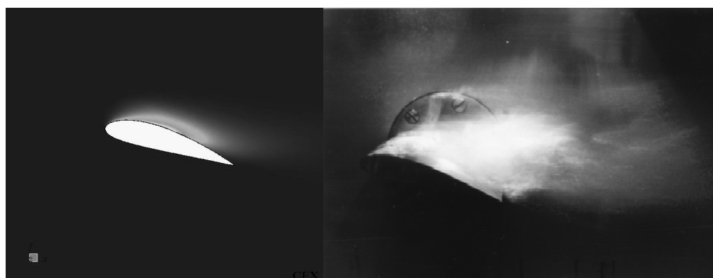
Sl. 6. Primerjava eksperimentalnih (a) in numeričnih (b) rezultatov za spremenljivko f za režim \alpha=16^\circ , Re=1 \cdot 10^6 , \sigma=2
