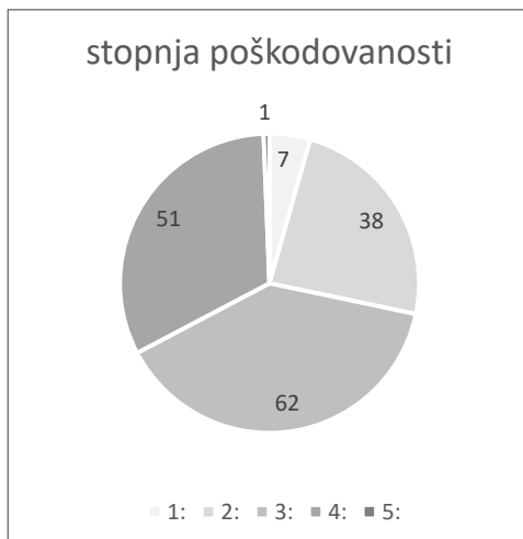
Slika 13: Porazdelitev stopnje poškodovanosti objektov v Brežicah in predmestju po EMS-98.
