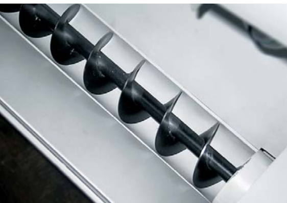
Tračna žaga DC300A je standardno opremljena s polžnim elevatorjem odrezkov, ki odstranjuje odrezke in z visokim izstopom omogoča, da se hladilno-rezalna tekočina odcedi in vrne v delovni proces
