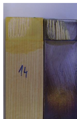
Slika 2. Sestava strižnih preskušancev s preklpom s pomočjo šablone (levo) in zlepljen preskušavec po porušitvi (desno).
