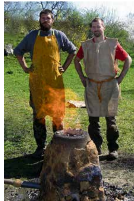
Jernej Cortese in Timotej Kruška sta prikazala starodavni postopek taljenja železove rude. Talili smo domačo železovo rudo iz Škrjanč.
