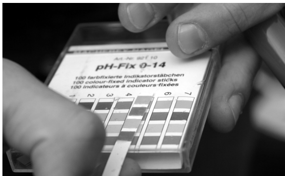
Slika 6: Meritev pH vode Avtor: Kardum Šibila, 2014.
