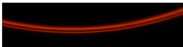
SLIKA 8. Natrijeva dvojna rumena črta (dublet). Zgornja črta ( \lambda = 589,0nm ) je dvakrat močnejša kot spodnja ( \lambda = 589,6nm ).
