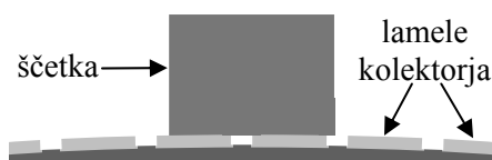
Slika 4.30: Dršenje ščetke po lamelah kolektorja
