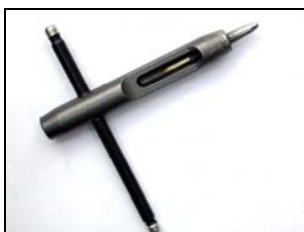
Slika 17: Eden najnovejših specifičnih orodij za odvzem mikro izvrtkov je Trepbor, ki ga je razvila italijanska skupina raziskovalcev iz Padove (Rossi in sod., 2006a) (Foto: L. Marion).
