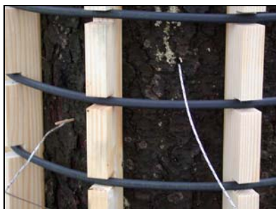
Slika 37: Merjenje temperature v kambijevem območju (Foto: M. Zupančič).
