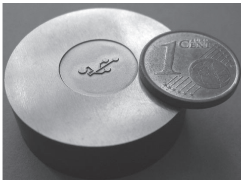
Sl. 5. Orodje za masovno proizvodnjo izdelano s PPME Fig. 5. Final tool produced by the MEDM process
