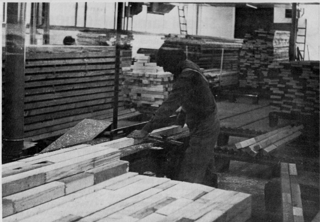
V novi hali v TO Mojstrana Poravnavanje pokončnikov za vhodna vrata
