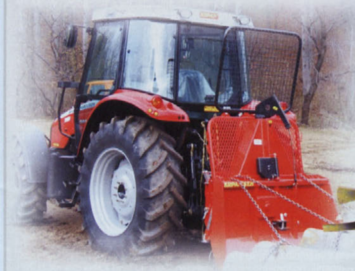
Traktorski gozdarski vitli od 3 do 8 ton (mehanski, elektro-hidravlični ali z daljinskim upravljanjem)
