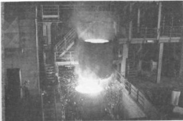
Slika 1 Pretakanje jekla v rafinacijsko ponvo Fig. 1 Steel flow into the refining ladle
