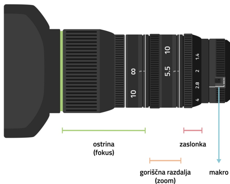
Slika 10: Shema objektiva profesionalne video kamere
