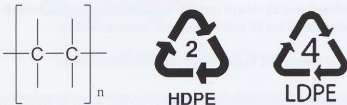
Slika 36: monomer polietilena (vodikovi atomi niso vpisani) ter mednarodna znaka za najbolj pogosti obliki polietilena, polietilen visoke gostote (na sredini, HDPE) in polietilen nizke gostote (desno, LDPE).
