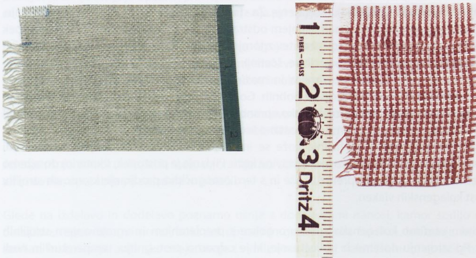
Slika 145: vezavi platno (levo) in keper (desno).
