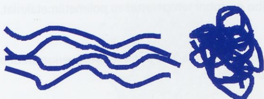
Slika 23: shematski prikaz štirih linearnih makromolekul v raztegnjenem in zvitem stanju.
