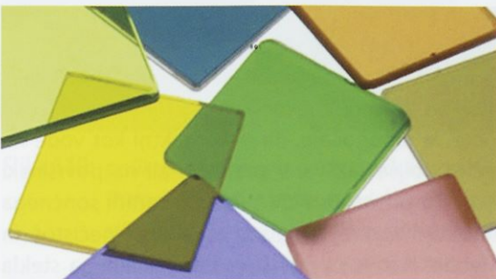
Slika 108: dvoslojno lepljeno obarvano steklo.
