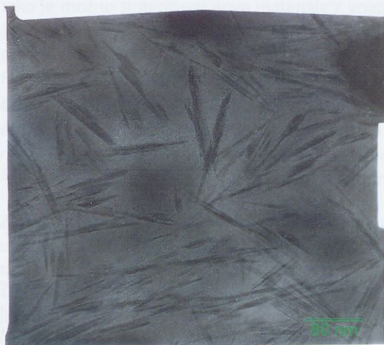
Slika 134: TEM posnetek celuloznanokristalov.
