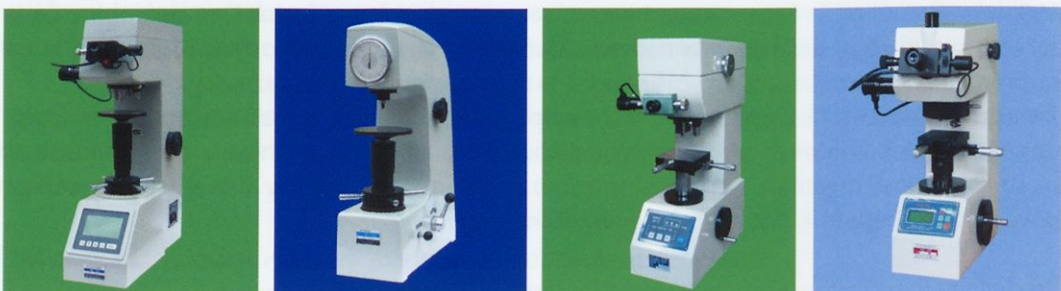
Slika 18: primeri instrumentov za določanje (od leve proti desni) Brinellove, Rockwellove, Vickersove in Knoopove trdote.
