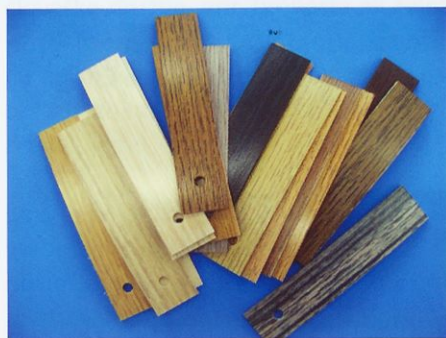
Slika 68: vzorci za robne trakove iz akrilonitril butadien stirena.
