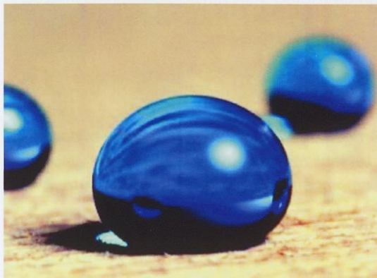
Slika 136: hidrofobna površina lesa, obdelanega s sredstvom z nanodelci.
