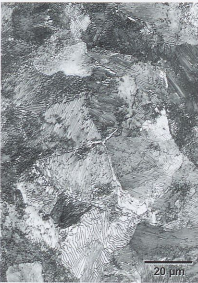
Slika 115: mikrostruktura ene od mnogih vrst jekel, ki jih ne uvrščamo med kompozitne materiale. ( http://www.matsci.ucdavis.edu/MatSciLT/EMS-162L/EMS-162L.htm 15.12.2007, poslali smo prošnjo za dovoljenje za objavo in ni bilo negativnega odgovora)
