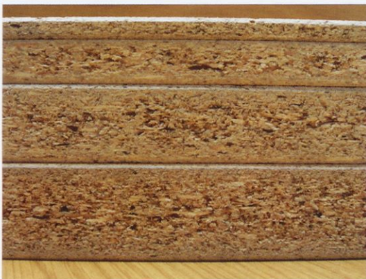
Slika 13: na oko vidne razlike v gostotnem profilu iverne plošče. (foto S. Medved)
