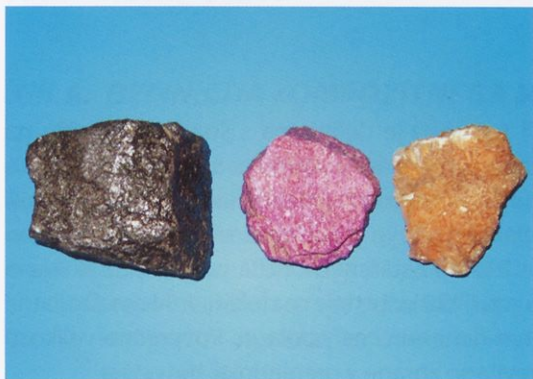
Slika 113: surovine za abrazivna zrna na upogibnih brusilnih sredstvih: levo dva primera elektrokorunda, desno kremen. (foto B. Kričej)
