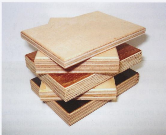
Slika 49: vezan les, zlepljen s fenolformaldehidnim lepilom. (foto M. Šernek)
