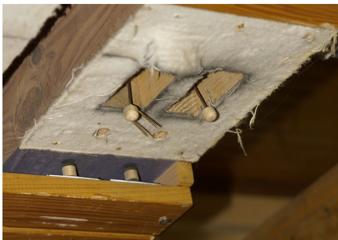
Jenkove orgle iz Djakova so med leti 2019 in 2021 generalno restavrirali v orglarski delavnici Škrabl v Rogaški Slatini. Na sliki je del sapnega kanal na spodnji strani pnevmatske sapnice. (jd)
