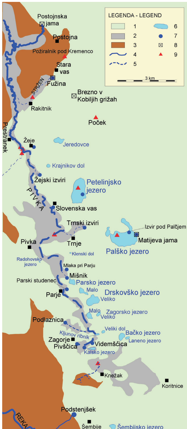
Slika 2: Hidrogeološka karta območja presihajočih Pivških jezer (Legenda: 1. kraški vodonosnik, 2. medzrnski vodonosnik, 3. zelo slabo prepustne plasti, 4. stalni površinski tok, 5. občasni površinski tok, 6. presihajoče jezero, 7. kraški izvir, 8. kraška jama, 9. ponor).
