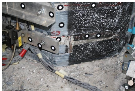
(b) Dokončno pretrganje ojačitvenega traku ob vpetju
