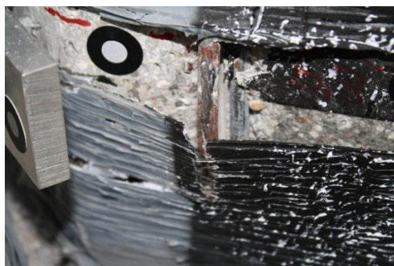
(a) Trganje traku na mestu uklona vzdolžne palice
