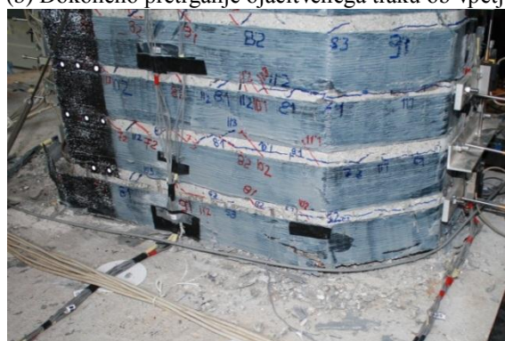
(d) Delaminacija traku ob vpetju (J)
