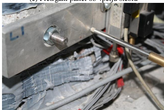
(e) Pretrgan ojačitveni trak (V)
