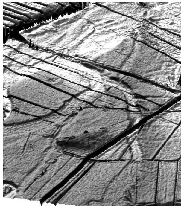
Slika 7. Tridimenzionalni prikaz dela digitalnega modela terena poplavne ravnice Iščice. Zelo dobro je moč razločiti starejšo teraso, razčlenjeno z opuščenimi koriti. Videti je celo moč obrežne nasipe ob koritih.
