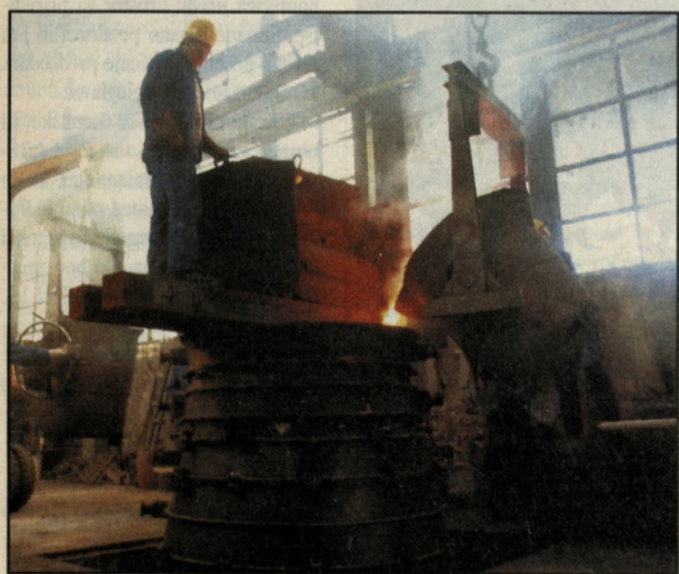
Med vlitvjem litine kositra in bakra v model zvona
