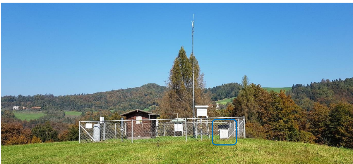
Slika 122: Prenosna postaja za meritve zunanjega sevanja na območju odlagališča Boršt
