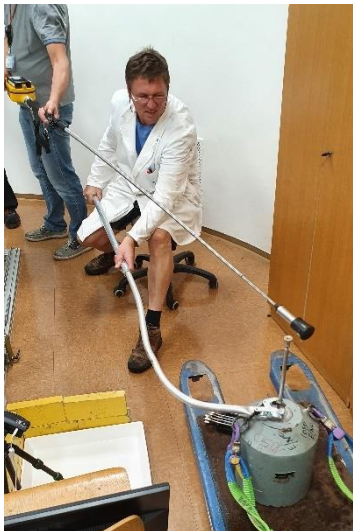
Slika 110: Menjava visoko aktivnega vira ^{137}\text{Cs} z aktivnostjo 355 GBq iz prenosnega vsebnika, vidnega na vozičku, z manipulatorjem na končno pozicijo v laboratoriju IJS. Slika je nastala med pripravo delovne skupine na izvedbo te menjave. (Foto: IJS)
