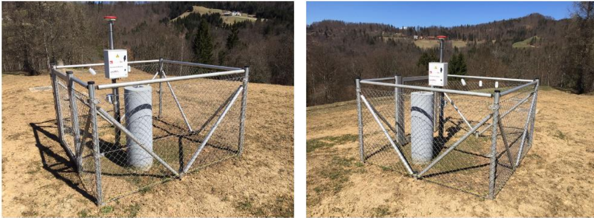
Slika 92: Opazovalna točka GPS nadzora stabilnosti območja odlagališča Boršt III GPS (GMX1) na prvotni lokaciji vremenske postaje Boršt Gorenja vas po odstranitvi vremenske postaje in dela merilne postaje Boršt (druga polovica leta 2020) (foto: RŽV)
