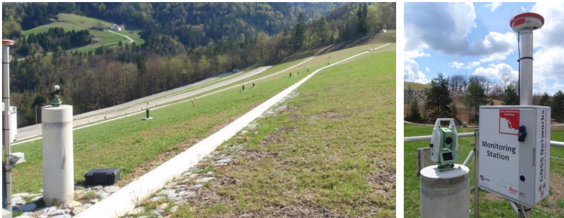
Slika 86: Stabilizacija opazovalnih točk mreže Vrtine-2 (foto: RŽV)
