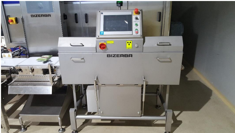
Slika 114: Rentgenska naprava za odkrivanje tujkov v prehranski industriji (Foto: inšpekcija URSJV)
