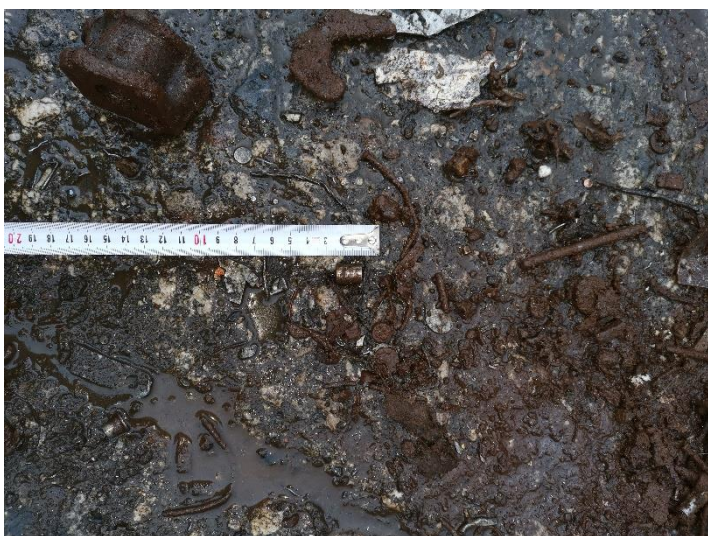
Slika 118: Radioaktivni odpadek z ^{152}\text{Eu} z aktivnostjo približno 1 \text{ GBq} najden med sekundarnimi surovinami (Foto: ZVD d. o. o.)
