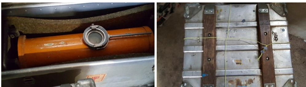
Slika 112: Rentgenska naprava nameščena v namenskem zabojniku (levo), zapečaten zabojnik z rentgensko napravo (desno). (Foto: inšpekcija URSJV)
