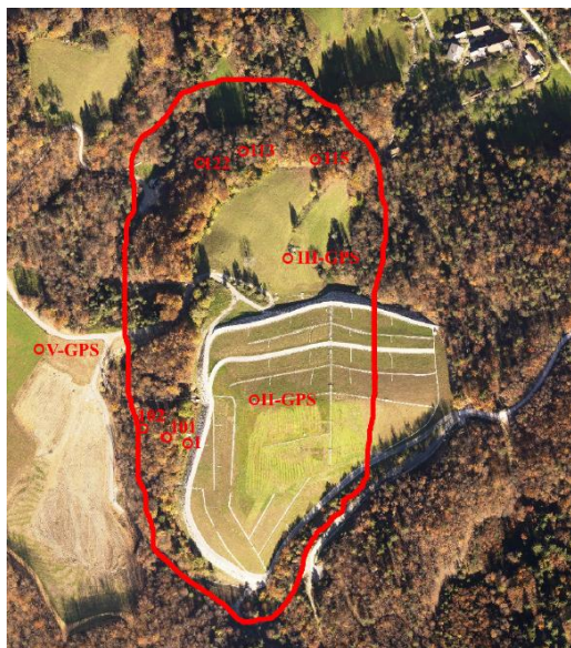
Slika 82: Okvirni obseg plazu na območju Boršta, opazovane točke GPS nadzora in geodetske mreže (točke 113, 115, 122, 1, 101, 102)
