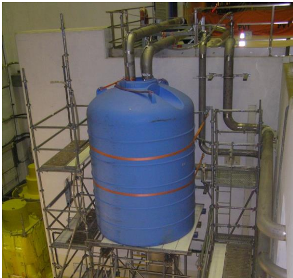
Slika 73: Testiranje pretoka sistema za alternativno hlajenje bazena z izrabljenim gorivom (Foto: inšpekcija URSJV)
