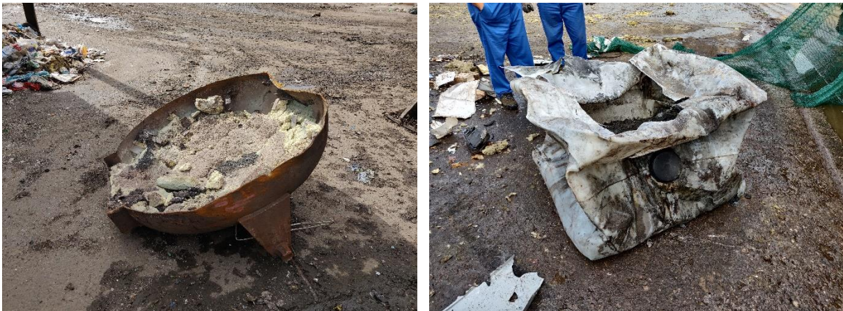
Slika 119: Levo: Šamotni obloga s povišano vrednostjo radionuklidov, najdena v pošiljki odpadnih kovin v podjetju Surovina d. o. o. na njegovi lokaciji v Mariboru. Desno: Cisterna z snovjo, ki vsebuje povišane vrednosti naravnih radionuklidov, najdena na lokaciji podjetja Dinos d. o. o. v Naklem (Foto: ZVD d. o. o.)
