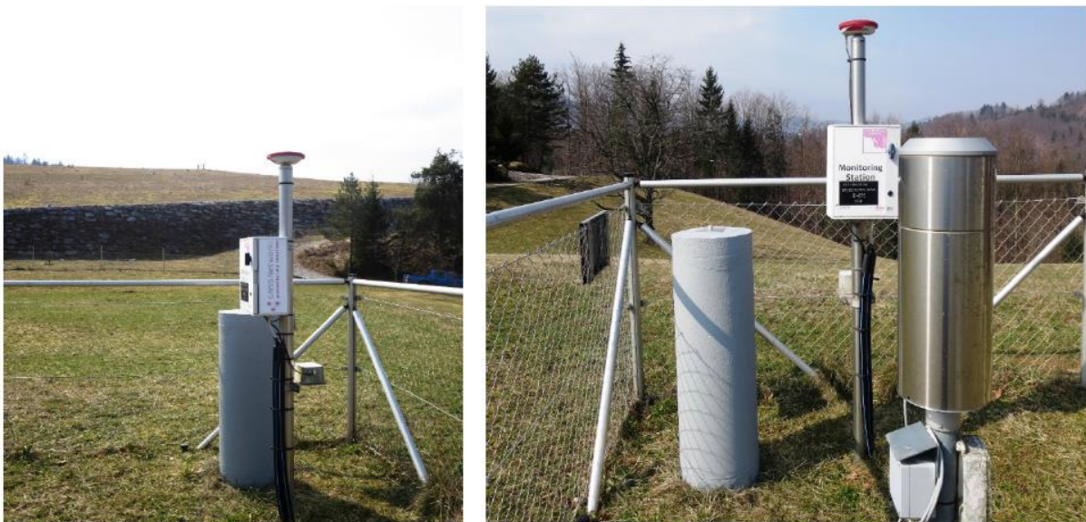
Slika 91: Opazovalna točka GPS nadzora stabilnosti območja odlagališča Boršt III-GPS (GMX1) na prvotni lokaciji vremenske postaje Boršt Gorenja vas (prva polovica leta 2020) (foto: RŽV)
