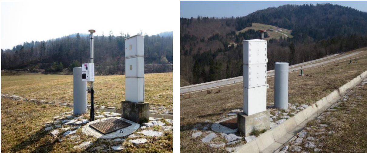
Slika 90: Opazovalna točka GPS nadzora stabilnosti območja odlagališča Boršt II-GPS (GMX2) na zgornji etaži odlagališča (foto: RŽV)
