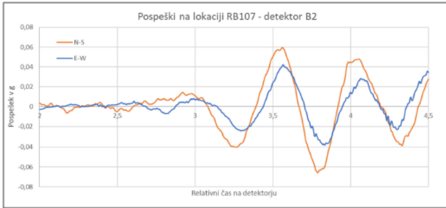
Slika 57: Pospeški, zabeleženi v reaktorski zgradbi v smeri N-S in E-W
