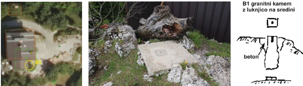
Slika 9: Položaj točke bočnega zavarovanja B1 (vir: PREG), njegov videz (foto: LGD, 1. 6. 2019) in skica njegove stabilizacije (vir: PREG).
