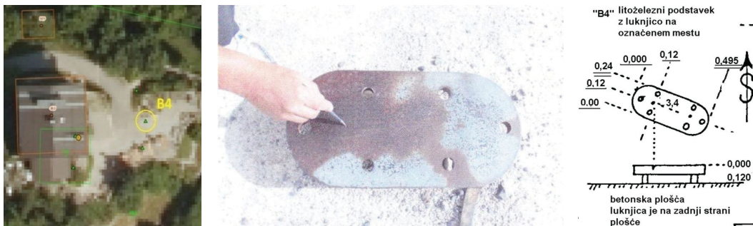
Slika 10: Položaj, videz in skica stabilizacije točke bočnega zavarovanja B4 (vir: PREG).
