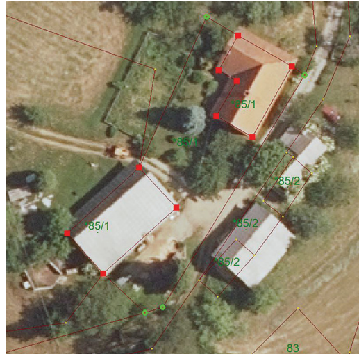
Sliki 3 in 4: Neustrezen vklop podatkov geodetske storitve na sloj ZKN brez prilagoditve okolice (levo) in kakovosten vklop podatkov s prilagojeno okolico (desno). ZK-točke, ki so predmet geodetske storitve, so prikazane z rdečimi kvadrati. ZK-točke, ki imajo spremenjene koordinate zaradi prilagoditve okolice, pa so prikazane z zelenimi krogi.
