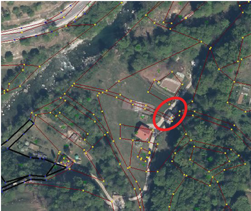
Slika 6: Vklp zemljišča pod stavbo z neposredno uporabo koordinat bi povzročil topološke napake na sloju ZKN.
