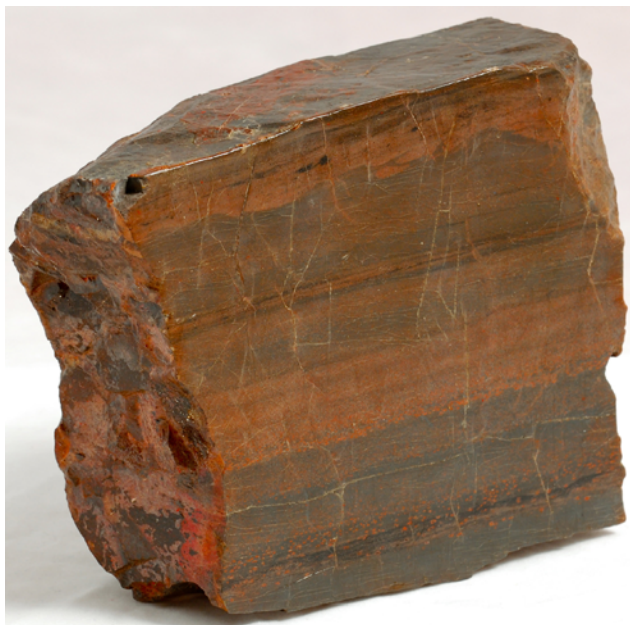
Sl. 19. Laminiran tufit. Zrna kalcedona prepojena s cinabaritom v tufitu. Zgoraj vidimo bolj ali manj razvito obremenitveno teksturo. Nekaj delcev se je že skoraj odvojilo od zgoraj ležeče plasti in gradijo teksturo 'pogreznjenih delcev'. V sredini in spodaj različno razvite postopne zrnivosti. Velikost vzorca 13 x 14 cm. Odkopno polje Kropač I/19. Foto: Jani Peternejl
