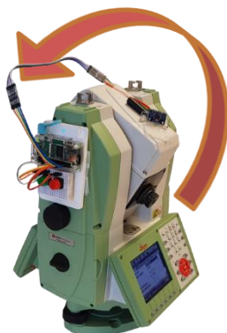
Slika 5.4: Postopek enostavnega testa kalibracije pospeškometra
