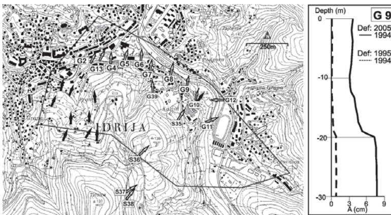
Figure 7. Results of the inclinometer measurement G9 Slika 7. Rezultati inklinometriških meritev merskega mesta G9
